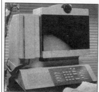
Συσκευή Εικονοτηλεφώνου για τηλεδιάσκεψη περισσότερων των δύο συνδρομητών ταυτόχρονα.
