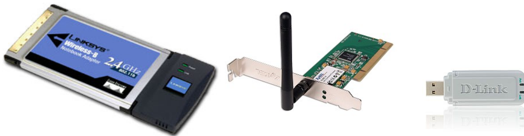
Εικόνες 14-16. Ασύρματες κάρτες δικτύου με διάφορες συνδεσμολογίες. (PCMCIA, PCI και USB από αριστερά προς τα δεξιά)
